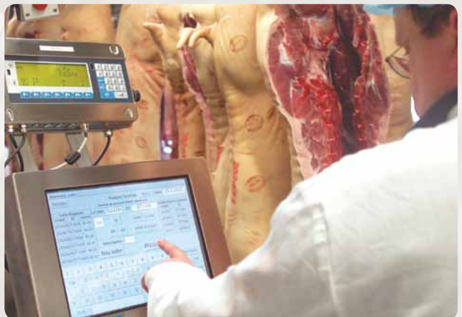
ビゼルバ社製の秤はTCP/IP経由でIPCに接続されている。ここで、食肉処理された豚の重さを測定。
