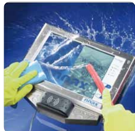
容易に洗浄・消毒が可能、食品加工に理想的な産業用 PC (写真: S12)
